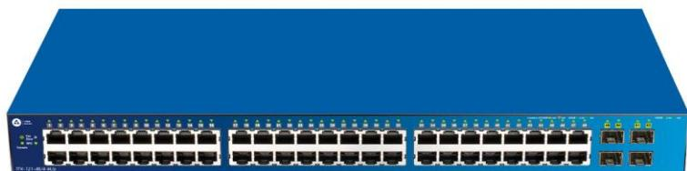
Коммутатор ТГК-121-48/4-М/р является идеальным решением для применения в сетях Metro Ethernet. Данный коммутатор оснащен 48 портами 10/100/1000Base-T для подключения по витой паре, а также 4 SFP-портами, применяемыми для организации подключения к высокоскоростной магистрали. Защита от статического электричества 6 кВ обеспечивает устойчивость к скачкам напряжения, а полный набор функций безопасности и аутентификации защищает сеть от внутренних и внешних угроз.
